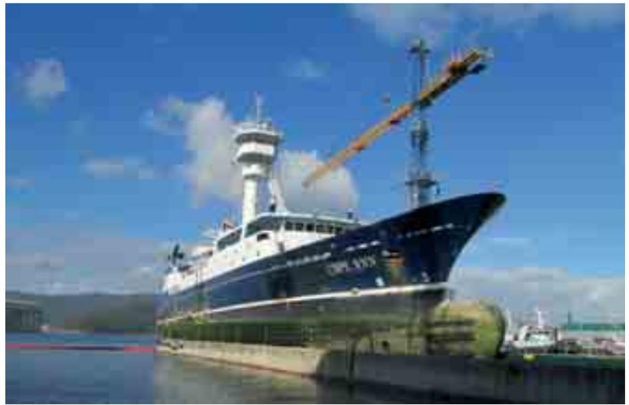
válvulas, pintado del casco, tanto obra viva como obra muerta, aplicándose un esquema de protección anticorrosiva adecuado y un par de capas de antifouling en la obra viva.
