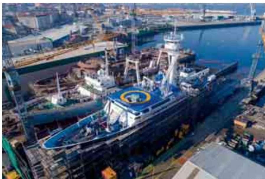
món. Aumento de un metro de la amurada del castillo, disminuyendo progresivamente hacia ambos costados. Chorro de la obra viva para la aplicación de protección anticorrosiva y anti-fouling de silicona. También, conlleva la construcción de una panga con motor CAT3508 y reductora Reintjes. C
